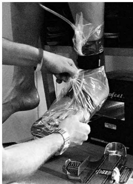
Obr. 5 – Nonweight-bearing (bez zatížení) proces zhotovení ortotické vložky Superfeet.
