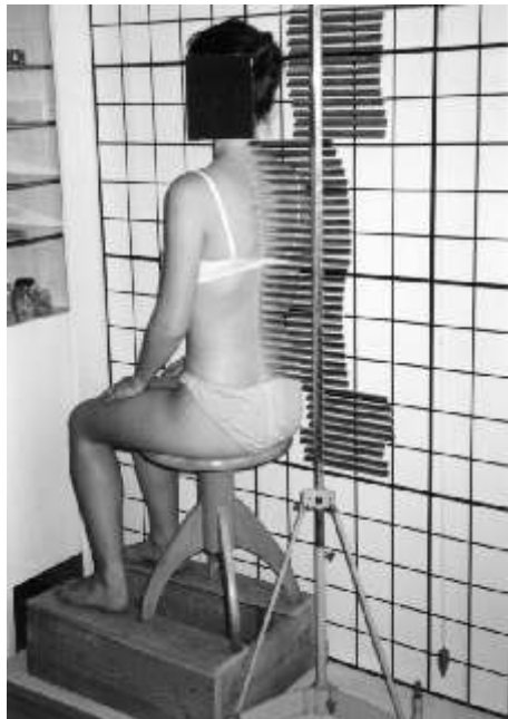
Obr. 2. Měření kolumnometrem vsedě.
