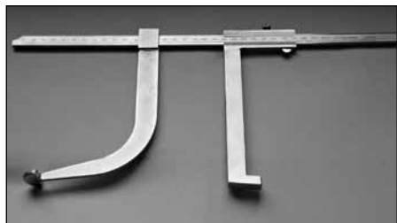
Obr. 4. Měřidlo délky vnitřního prostoru obuvi.
