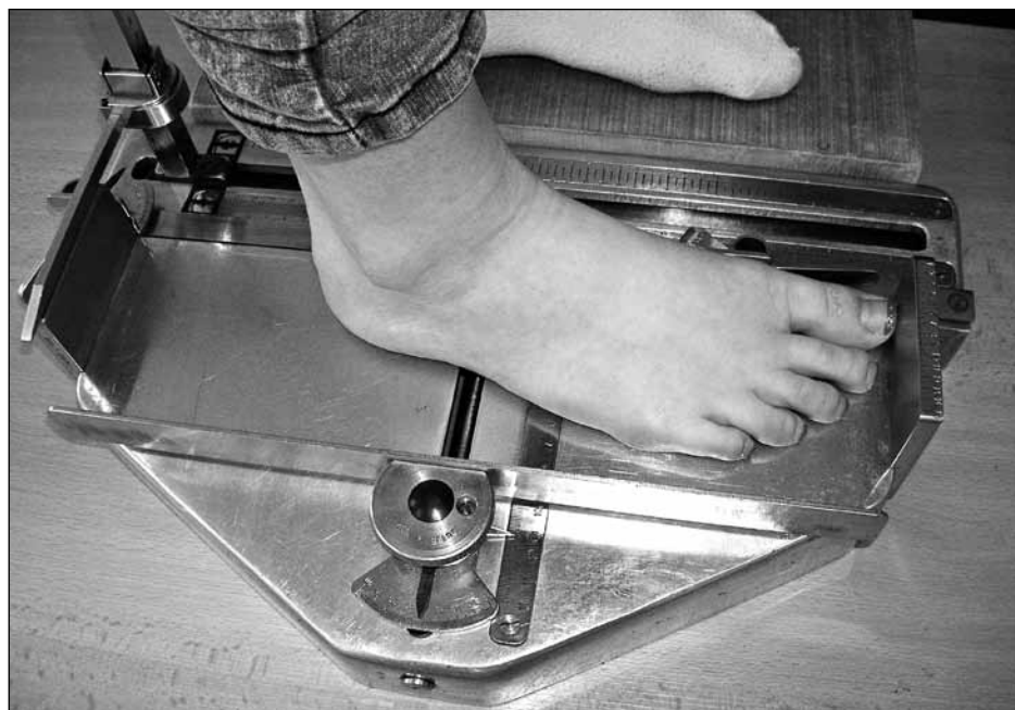
Obr. 2. Dotykový měřicí přístroj pro přímou délku chodidla.obuvi..
